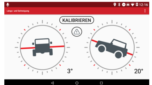
Integrierte Sensoren liefern Informationen sowie Warnhinweise zur Längs- und Seitenneigung des Fahrzeugs.
