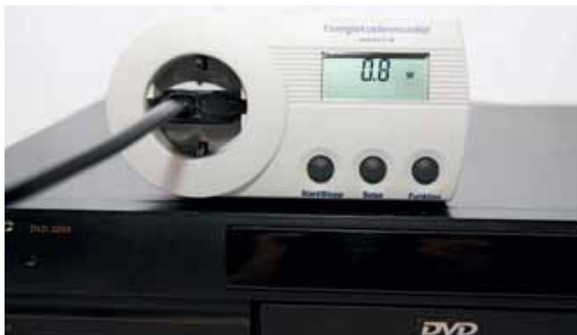
Mit einem Strommessgerät lässt sich der Stromverbrauch von Elektrogeräten im Betrieb und im Stand-by-Zustand ermitteln.
